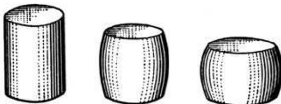
Рисунок 1.1. Деформация стального образца при сжатии
